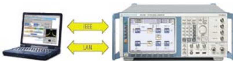
Дистанционное управление R&S SMU200A по шине IEEE и по локальной сети
